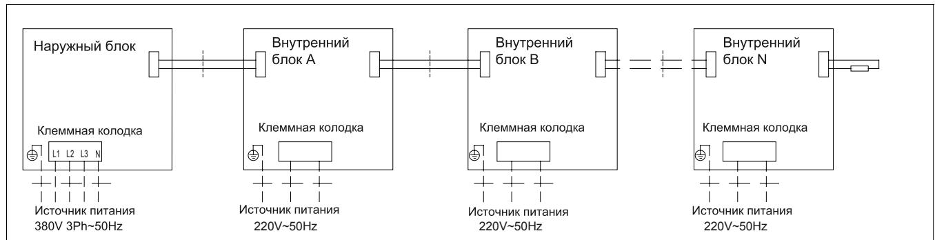
К каждому наружному блоку возможно подключить максимум 16 внутренних блоков. Если количество внутренних блоков  $> 16$  и  $\leq 32$ , то подключить их можно к двум наружным блокам. Если количество внутренних блоков  $> 32$  и  $\leq 48$ , то их можно подключить к трем наружным блокам. Если количество внутренних блоков  $> 48$  и  $\leq 64$ , то их можно подключить к четырем наружным блокам.
