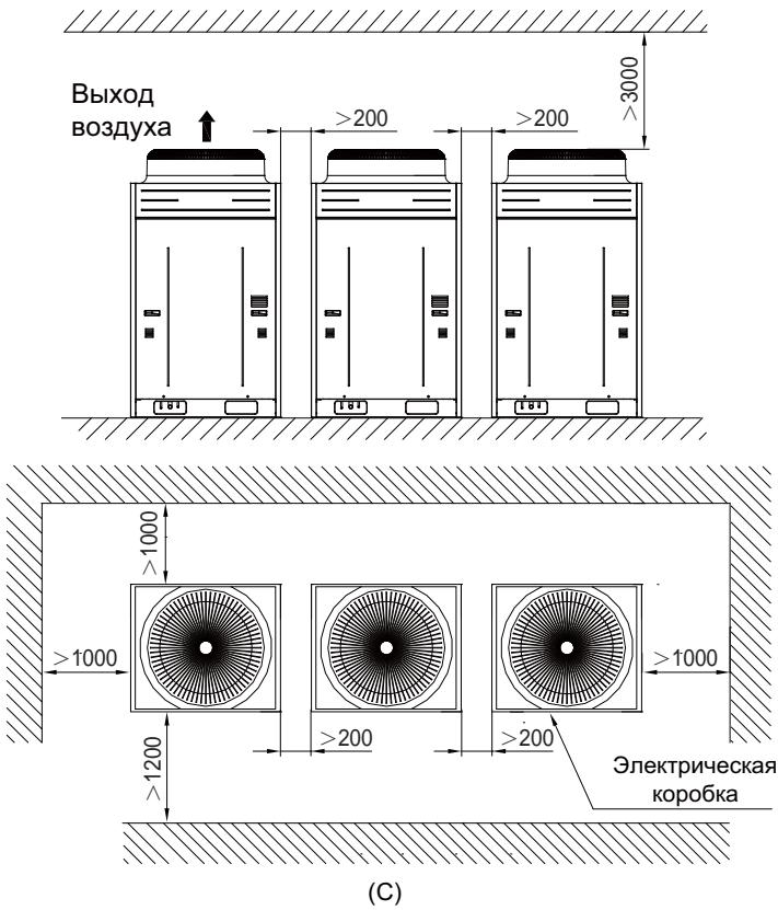
(d) Размеры установки наружных блоков 1350-1800
