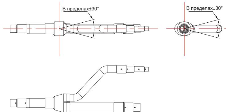
При подключении большого количества внутренних блоков, каждая труба должна быть отмечена, во избежание неправильного подключения.
